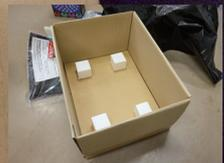
※その辺にあった段ボール発想はいいが、どう再現するのが難問だった。現在は排熱、遮光、耐水等の課題を解決した装置で研究をしているが、学生自主研究の時には段ボールにテープLEDを貼り、水槽が滑らないように発泡スチロールで土台を作成。蓋がなかったので遮光シートで全体を覆って光を遮断した。工作から始まった末だに捨てられない特別な段ボール箱である。
