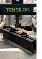
バチの物理性評価・3点曲げ試験
