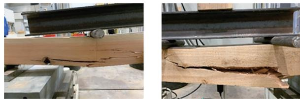
(1) 節あり試験体(接合部なし) (2) 節あり試験体(接合部なし)
