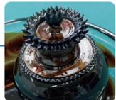
ヨークを磁石に付けて磁性流体を吸着した様子
