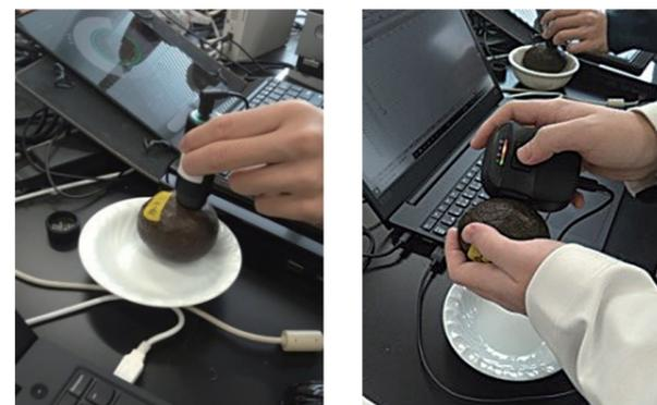
図1 可視光(左)および近赤外光(右)反射率の測定の様子
